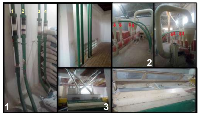
Figura 8 – Canos de sucção; exclusiva que separa o grão do ar; cilindro de moagem
