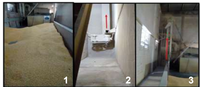
Figura 4 – Grão na moega; transporte do grão até o equipamento de limpeza
