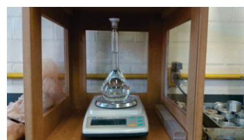
Figura 11 – Medição da massa do "Picnômetro + Água"
