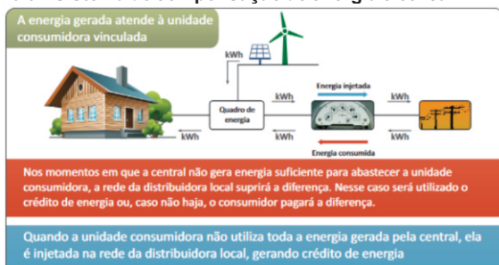
Figura 6 – Sistema de compensação de energia elétrica.
