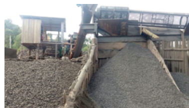
Figura 3 – Material é separado quanto a sua granulometria quando há britadores no garimpo.
