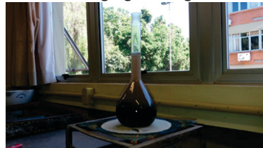
Figura 10 – "Picnômetro + Agregado + Água"
