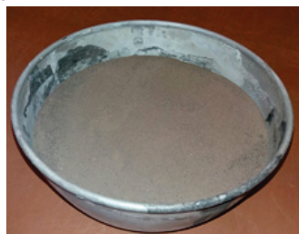
Figura 14 – Pó retido na peneira de nº 40 para realização do ensaio de plasticidade.
