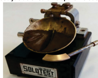
Figura 15 – Execução do ensaio no aparelho Casagrande
